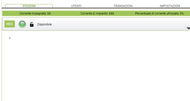
À ce stade, il est possible d'ajouter de nouvelles stations satellites, en gardant à l'esprit que le système prend en charge un maximum de 16 stations.
